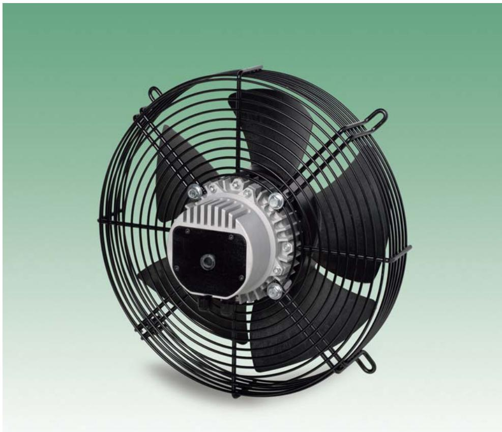
Il motore, con elettronica montata a bordo, è chiuso in una carcassa di alluminio pressofuso, particolarmente adatto all'uso negli ambienti aggressivi. Il grado di protezione IP55 garantisce un elevato grado di isolamento contro la penetrazione di corpi solidi e liquidi. Il cavo di potenza e il cavo di segnale, 0-10 Vdc, sono connessi alla scheda elettronica attraverso due PG a tenuta stagna.
